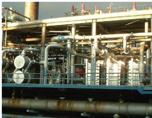
石油化学プラントのクエンチウォーターの冷却 (セミ溶接ガasket型PHE)
